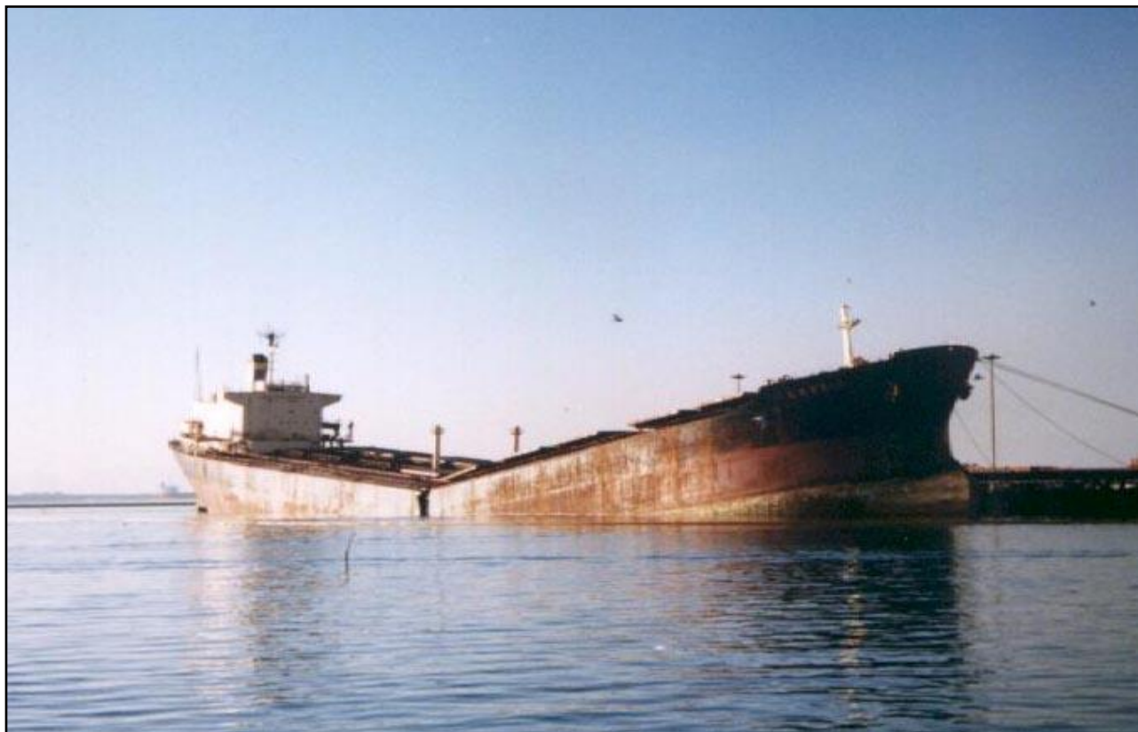
Рис. 2. Пример поперечного разлома судна-балкера
