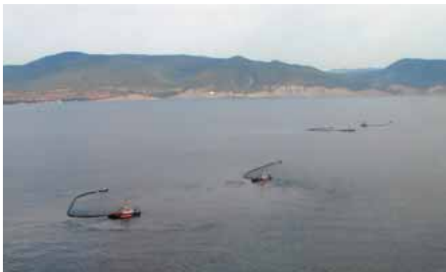
▲ Отработка построения J-образных мобильных ордеров для локализации нефти методом траления в ходе тренировочных учений на Морском терминале АО «КТК-Р» ▲ Development of J-shaped mobile orders for oil localization by trawling during training exercises at the Marine terminal of CPC-R JSC
